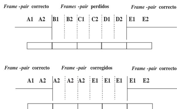
**Figura 8.** Ejemplo de corrección de *frames-pairs* erróneos.
