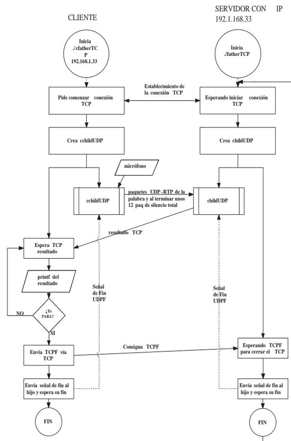
Figura 2. Esquema general del sistema cliente/servidor DSR.
